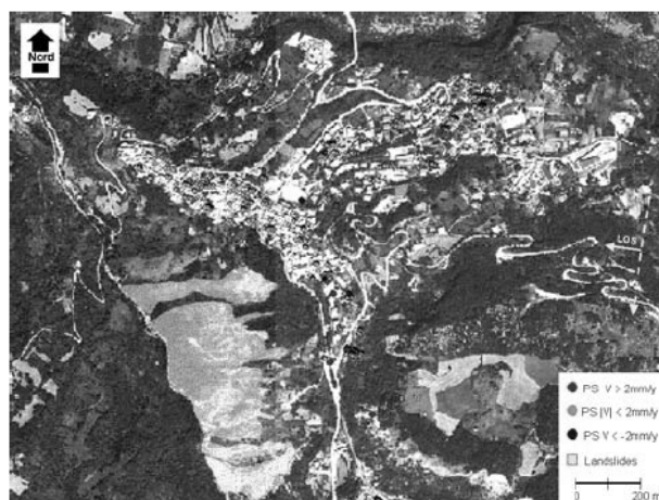
Figura 1- Mappa di velocità misurate su bersagli coerenti sul sito di Caramanico.
