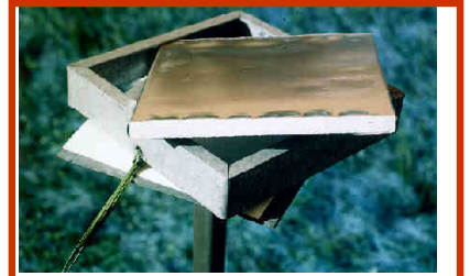
Gremimetro "Schleusener" (smontato) 15 cm x 15 cm. polistirolo + alluminio
